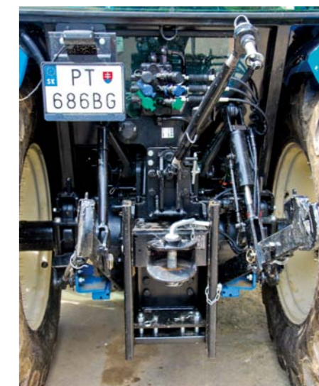
Pri pohľade zozadu dominuje výškovo nastaviteľný etážový záves s mechanickým zaistením. Veľkým plusom pre pána Gondu je aj zvlášť hydraulicky ovládané pravé rameno zadného trojbodového závesu.
