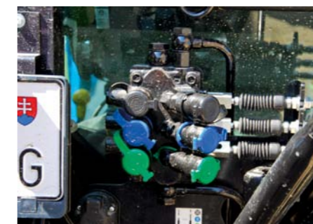
3 hydraulické okruhy vzadu a 2 hydraulické okruhy vpredu s predprípravou na čelný nakladač sú tu v základnej výbave.
